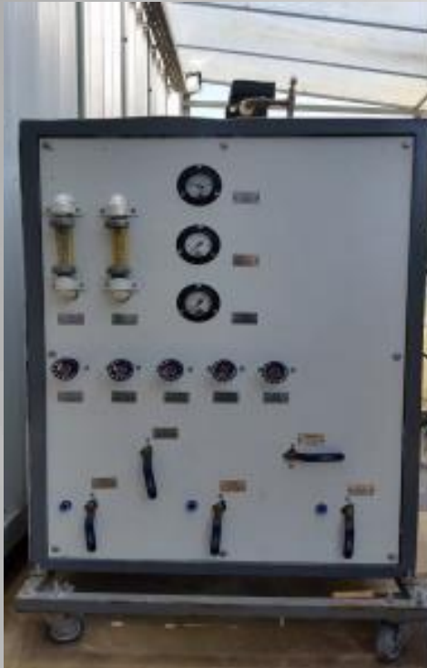
(a) Equipamento de Microfiltração
