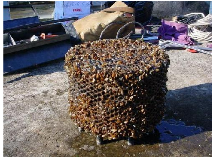
Grade de proteção - Captação
