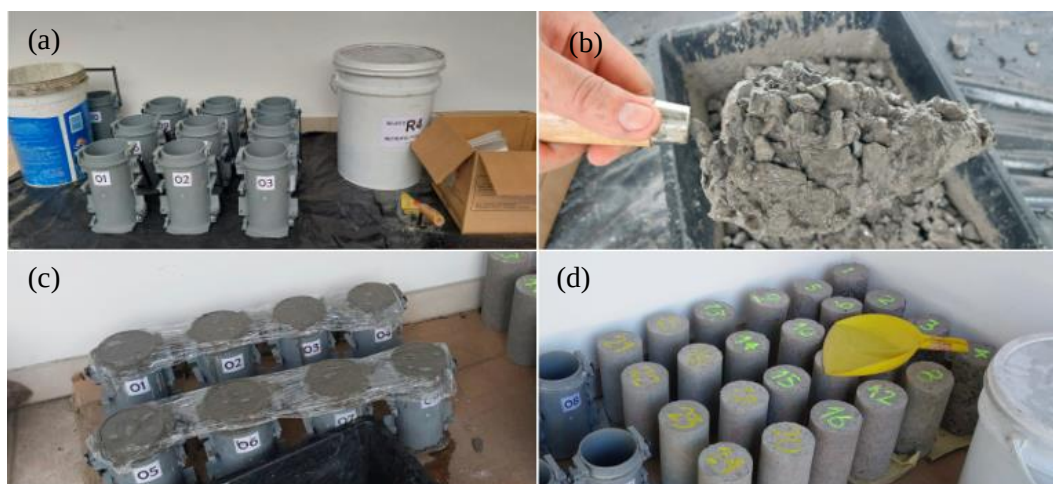
Figura 2: (a) Materiais e equipamentos; (b) mistura dos materiais; (c) moldagem dos corpos de prova; e (d) desmoldagem dos corpos de prova.
