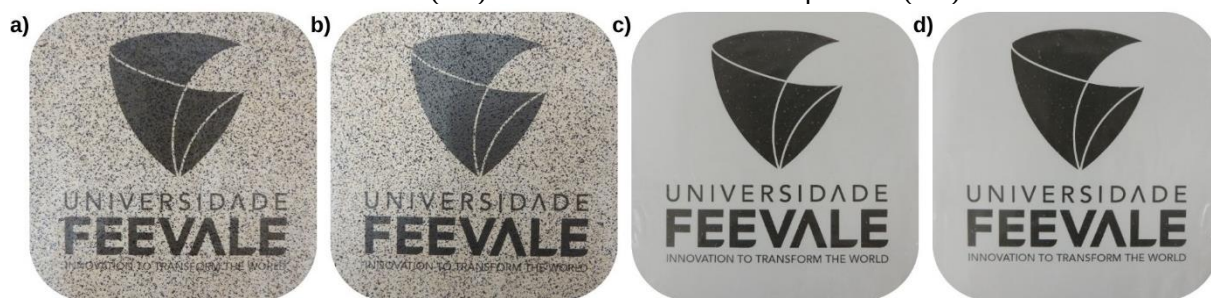
Figura 1 - Fotografias da superfície inferior (a-c) e superfície superior (b-d) do compósito de amido e borra de café (a-b) e do filme de amido termoplástico (c-d)
