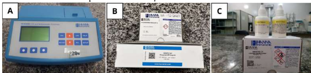
Figura 4 - A) Multiparâmetro; B) Reagentes usados para a caracterização de P; C) Reagentes usados para a caracterização de Amônia.
