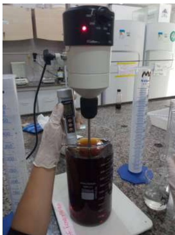
Figura 5 - Síntese de estruvita em escala de bancada.
