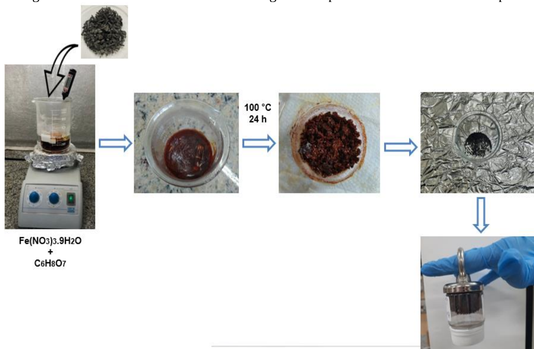
Figura 1 – Procedimento de síntese da magnetita suportada no biochar de Eucalipto.
