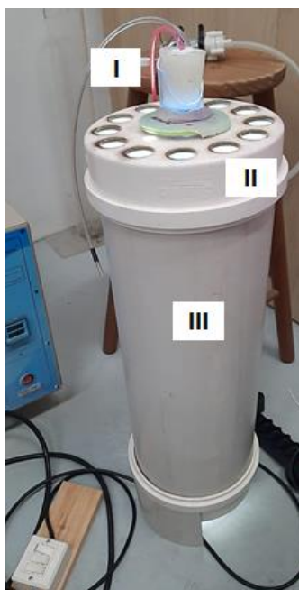
Figura 2 – Imagem do reator de luz visível, composto por: (I) Borbulhador (II) Conjunto de lâmpadas de LED e (III) Tubo de quartzo.
