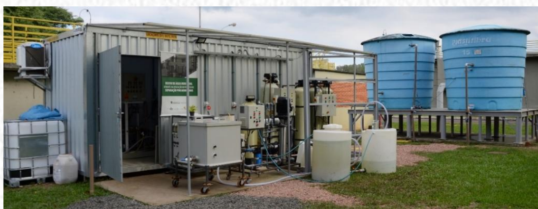
Figura 2 – Unidade piloto de tratamento de efluente petroquímico para reúso.
