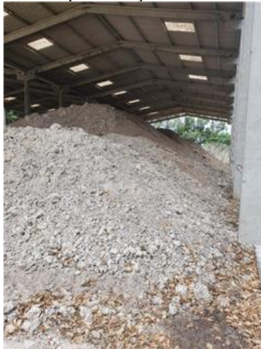
Figura 1: Armazenamento do lodo na UGL após caleação.
