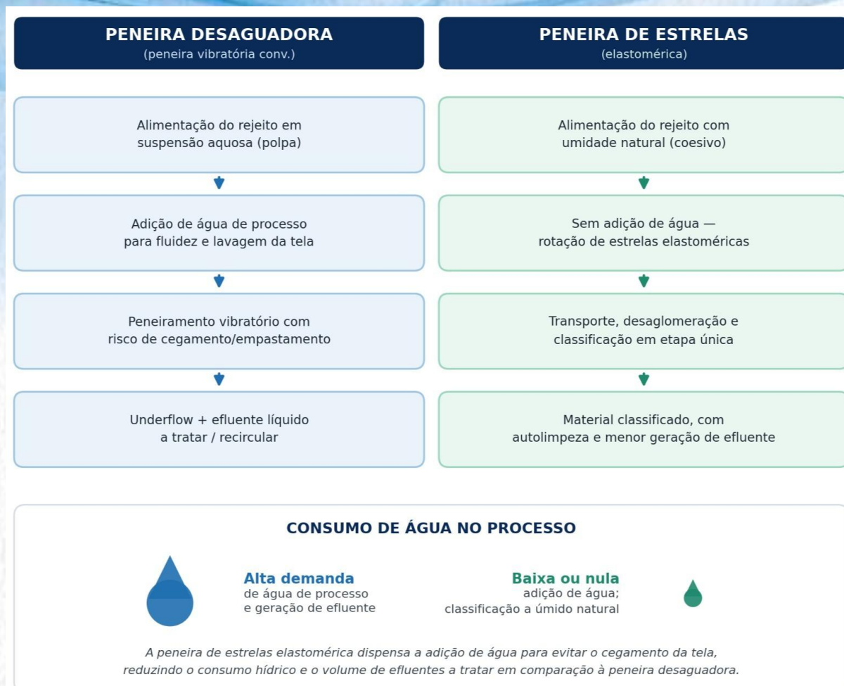
Figura 1. Processos de peneiramento por peneira desaguadora e peneira de estrelas elastomérica.
