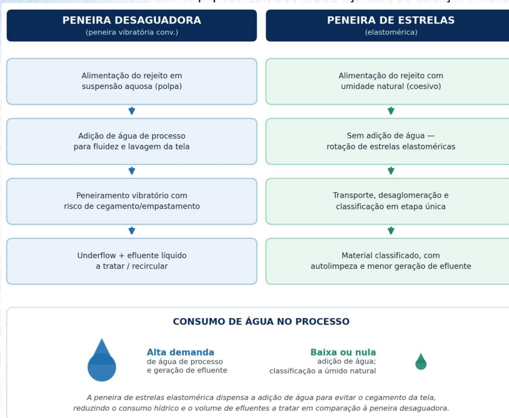
Figura 3. Modelo conceitual para a redução de passivos ambientais por meio do reprocessamento de rejeitos de barragens de mineração.
